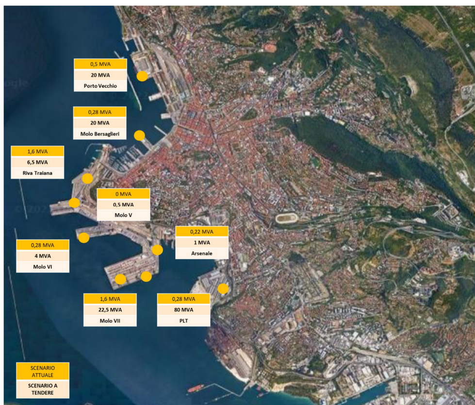
Figura 19. Richieste attese di nuovi allacciamenti di carichi elettrici del Porto di Trieste.
